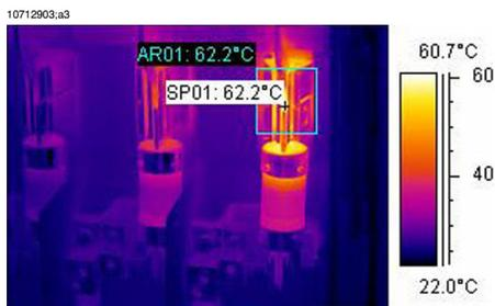
**Figura 17.3** Uma imagem de infravermelhos de uma caixa de fusíveis em que é apresentada a temperatura máxima
