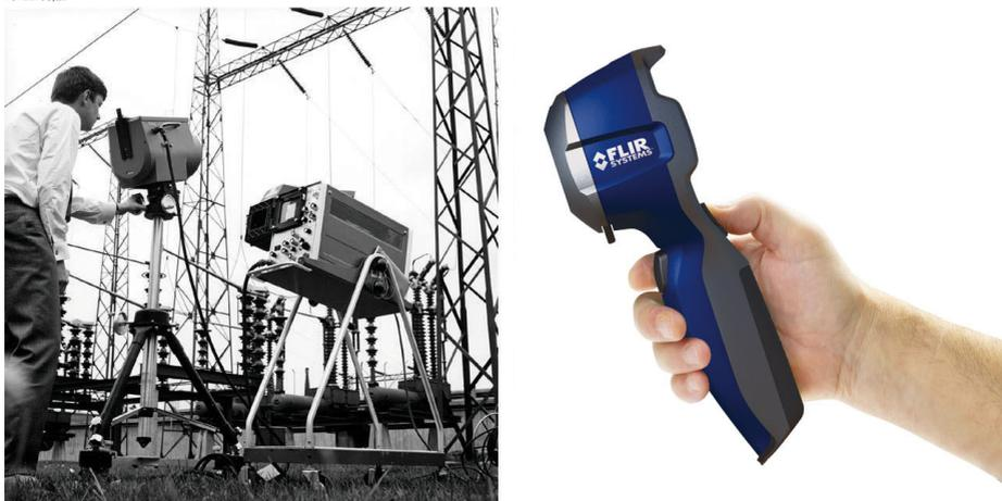
**Figura 18.2 ESQUERDA:** Thermovision® Modelo 661 de 1969. A câmara pesava cerca de 25 kg, o osciloscópio 20 kg e o tripé 15 kg. O operador necessitava ainda de um conjunto de geradores de 220 VCA e de um recipiente de 10 litros de nitrogénio líquido. À esquerda do osciloscópio, é possível ver-se a ligação à Polaroid (6 kg). **DIREITA:** FLIR i7 de 2009. Peso: 0,34 kg, incluindo bateria.
