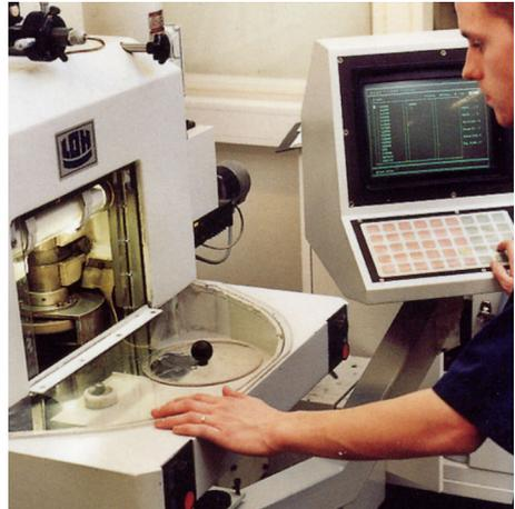
**Figura 18.4 ESQUERDA:** Torno para trabalhar diamantes; **DIREITA:** Polimento da lente
